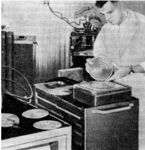
Figura 18. Instalación para estampar piezas metálicas por el método magnetoimpulsivo
